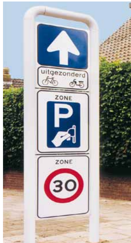
▲ Een naambord met S 60 staanders. Het bovenste paneel is uit kunststof en de onderste panelen uit aluminium. Het geheel is in diverse RAL kleuren gepoedercoat.
